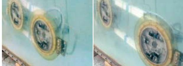
2個の吸盤が吸着したまま尺取り移動
